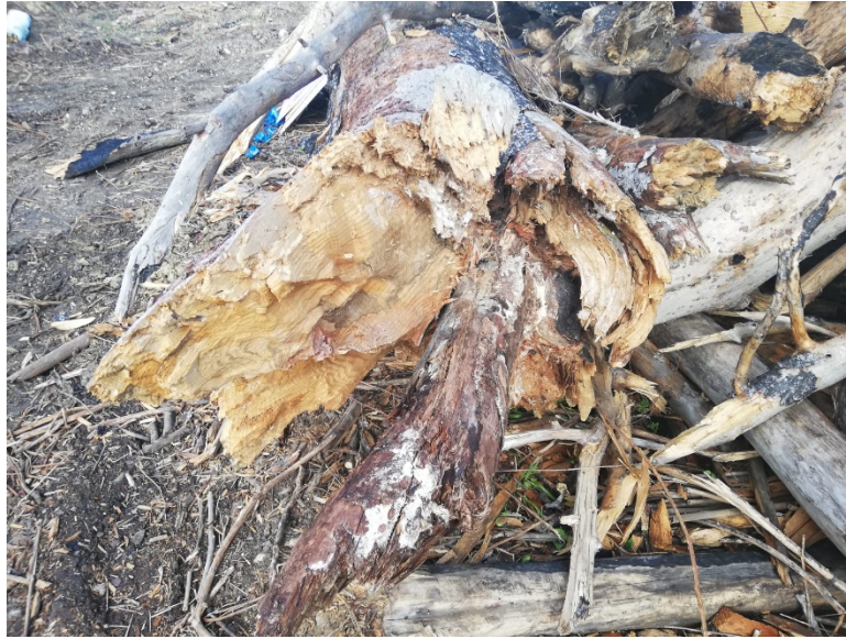
Fotografia 2: Legno degradato con ife fungine
