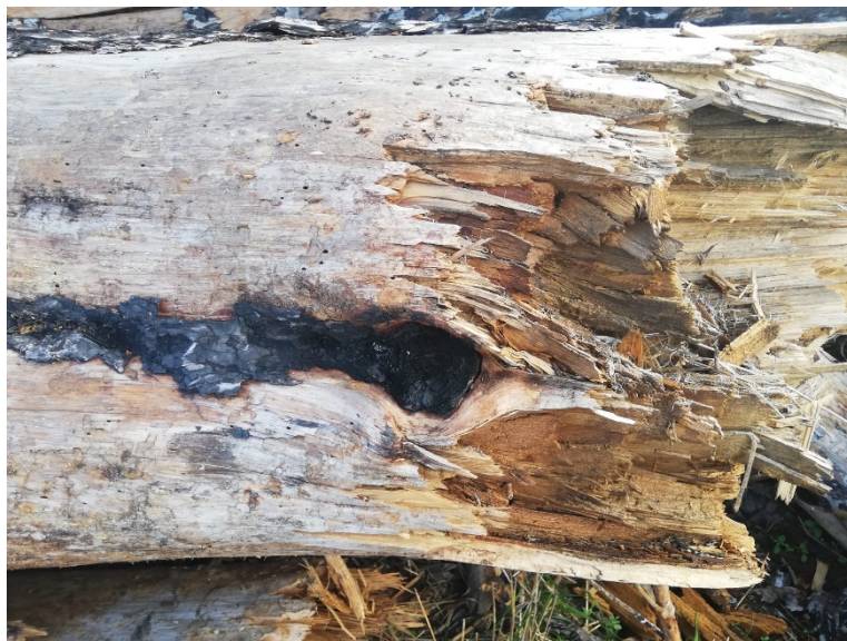
Fotografia 3: Legno degradato con segni di carbonizzazione
