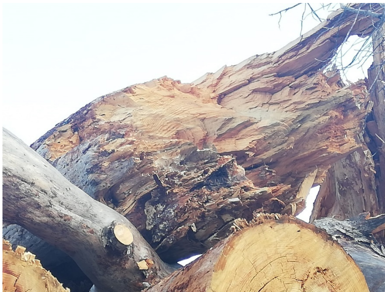
Fotografia 4: tronco con segni evidenti di degradazione dovuta a funghi della lignina
